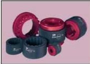
I giunti flessibili Eurogrip® sono progettati per collegare due assi esposti a disallineamento o a movimenti assiali e possono eliminare la tensione che risulterebbe da un giunto rigido. Sono composti da un manicotto di gomma e da due estremità metalliche.
